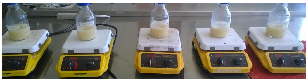
Figura 1.- Proceso de fermentación para la obtención de metabolitos de B. subtilis
